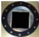
CCD di un telescopio
