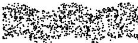
In un'onda longitudinale lo spostamento è parallelo alla propagazione
